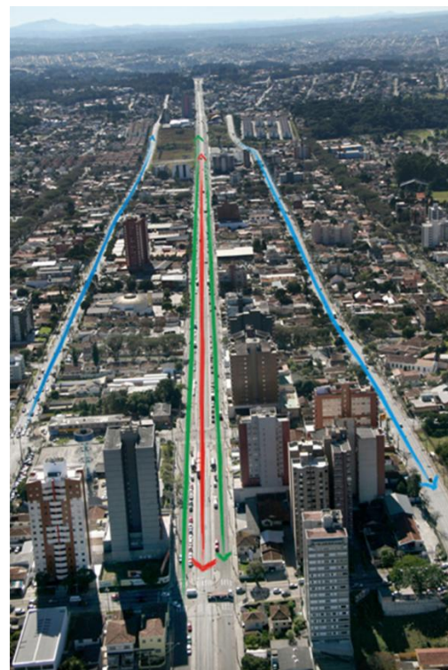
Röda pilar visar stråk för BRT-linjerna, gröna pilar visar stråk för angöringstrafik och blå pilar visar stråk för genomfartstrafik
